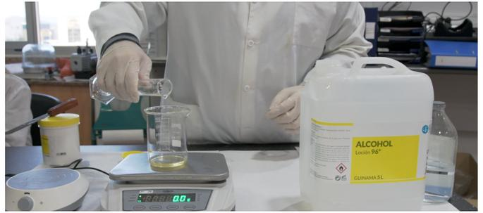
**Paso 2.** Medimos la fase II y la incorporamos a la fase I, homogeneizando completamente con agitador magnético a media velocidad, sin generar burbujas.
